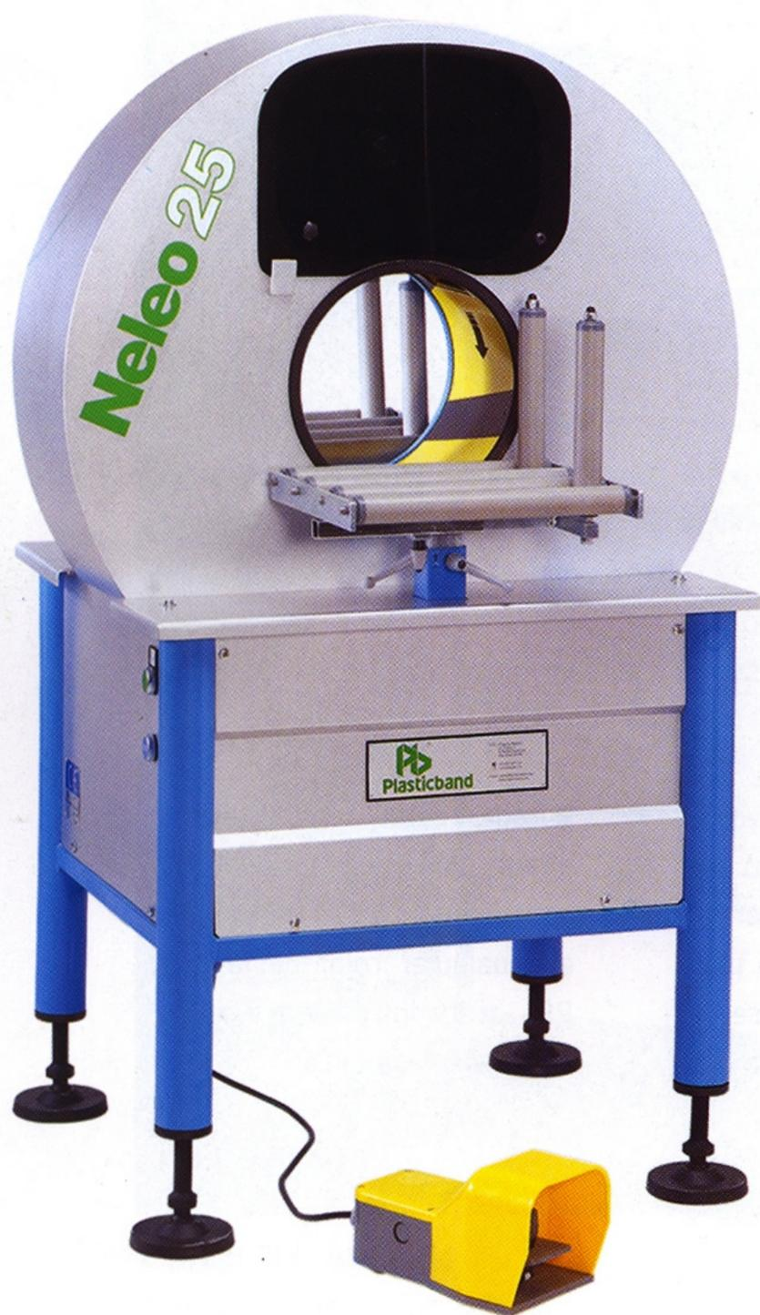
Las envolvedoras orbitales fabricadas por Plasticband están diseñadas para envolver con film estirable perfiles, barras, mobiliario, puertas, planchas, tableros, y otros productos de diversas dimensiones y formas, protegiéndolos
