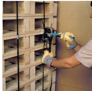
3. Insertar el fleje (desde el dispensador) en el rodillo. Tensar el fleje accionando la palanca.
